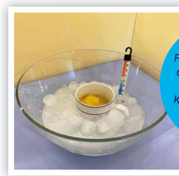
Stelle den Becher mit Saft in die Schüssel mit der Eis-Salz-Mischung und rühre den Saft regelmäßig um.
