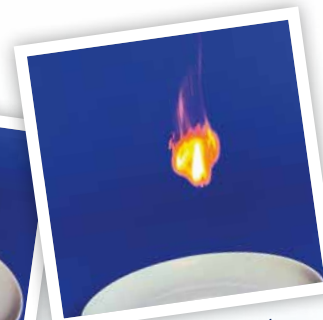
Der Teebeutel ist verbrannt. Die Flamme mit der Asche steigt mit der warmen Luft nach oben.
