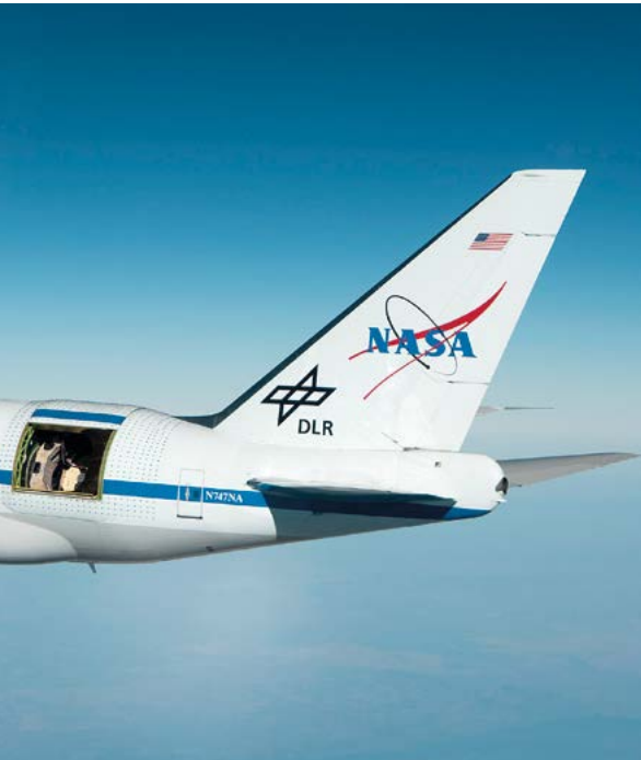
Rumpf der Boeing 747 SP ist das in Deutschland gebaute 2,5-Meter-Teleskop sichtbar. Bild: Jim Ross/NASA
