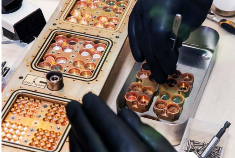
Entnommen Unter einer Schutzatmosphäre werden Hunderte Proben von EXPOSE-R2 vorsichtig für die Auswertung vorbereitet.
