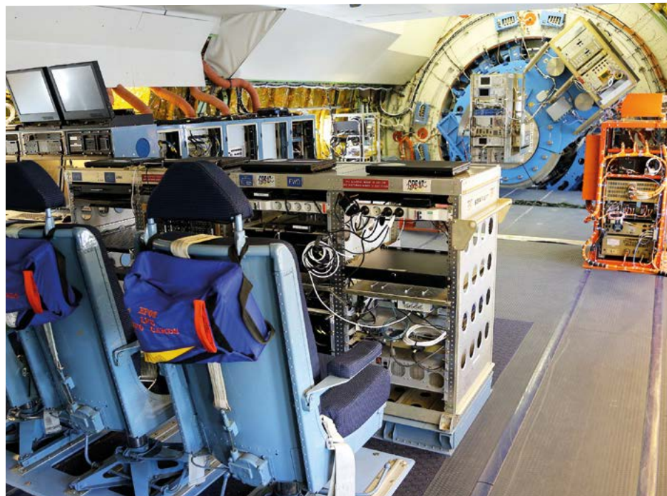
Technik statt Passagiere Im Bauch des Flugzeugs sind die Arbeitsplätze für die Wissenschaftler sowie die gewaltige Mechanik des Teleskops untergebracht. Bild: DLR (CC-BY 3.0)
